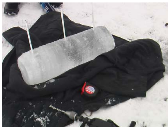
Рис.5. Измерение температуры разных слоев в керне льда.
